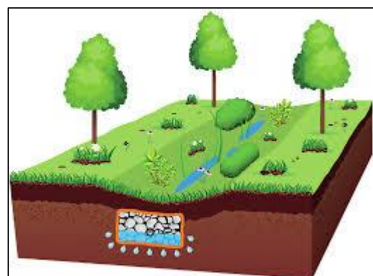
Illustration schématique d'une noue d'infiltration (Grand Albigeois)
