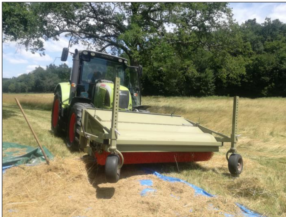
Outil de récolte de graines herbacées locales, développé par le CREN
